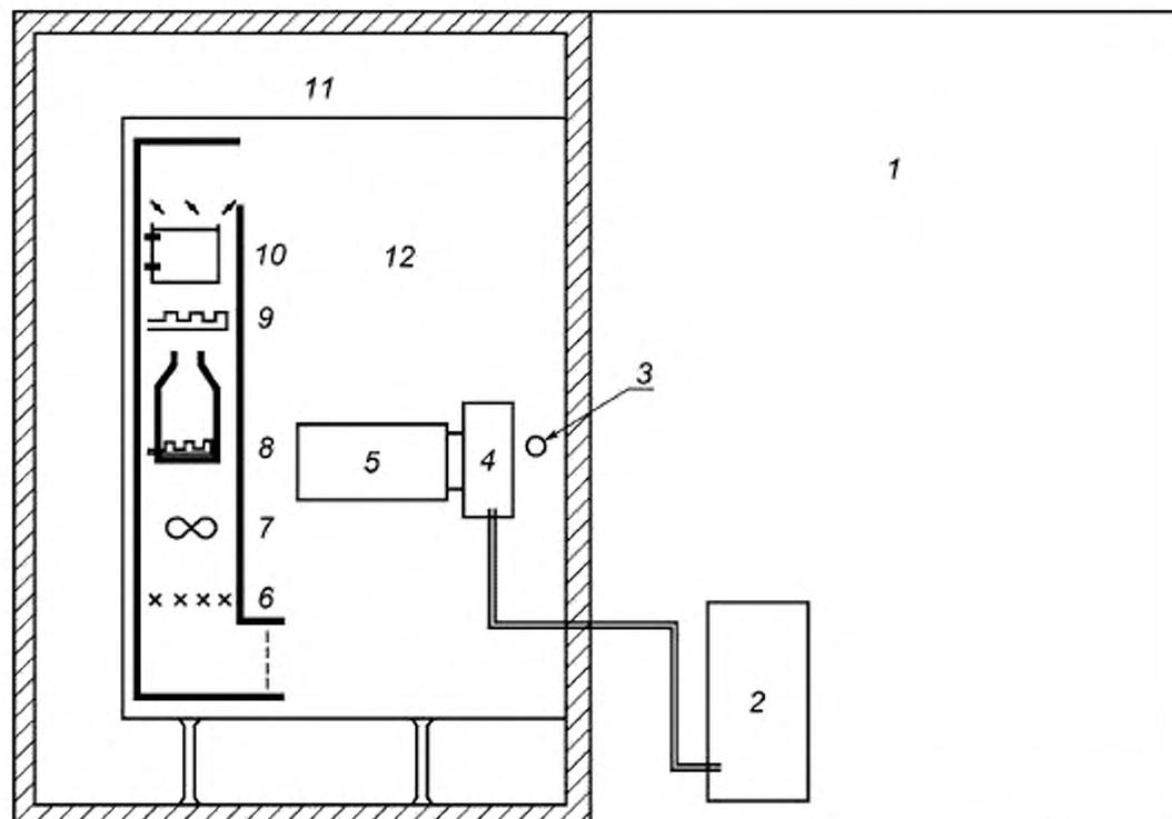
1 — отсек наружной стороны; 2 — наружный блок испытываемого оборудования; 3 — трубка отбора пробы воздуха; 4 — внутренний блок испытываемого оборудования; 5 — аппарат измерения воздушного потока; 6 — смеситель; 7 — вентилятор; 8 — увлажнитель; 9 — теплообменник для нагрева; 10 — теплообменник для охлаждения; 11 — пространство с регулируемой температурой воздуха; 12 — отсек внутренней стороны
