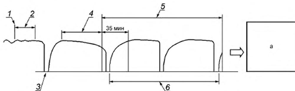
1 — достигнуто соответствие с допустимыми отклонениями испытания; 2 — период предварительной подготовки (минимально — 10 мин); 3 — размораживание в конце периода предварительной подготовки; 4 — период равновесия (60 мин); 5 — период сбора данных (3 ч); 6 — два полных цикла размораживания,  $\Delta$  внутреннего воздуха; а — завершить испытание, когда период сбора данных равен 3 ч
