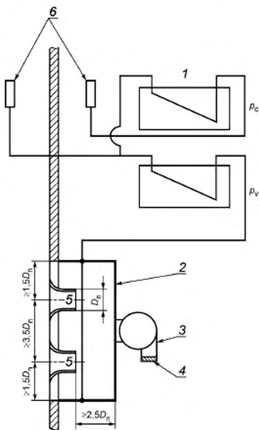
1 — манометры давления; 2 — разгрузочная камера; 3 — вытяжной вентилятор; 4 — заслонка; 5 — сопло; 6 — трубка забора;
