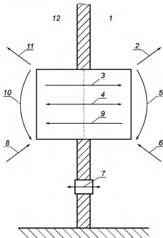
1 — наружная сторона; 2 — выпуск наружу; 3 — выпускной канал; 4 — утечка; 5 — возврат выпущенного воздуха; 6 — забор наружного воздуха; 7 — отверстие выравнивания; 8 — забор внутреннего воздуха; 9 — вентиляция; 10 — частичный выпуск кондиционированного воздуха; 11 — впуск кондиционированного воздуха внутрь; 12 — внутренняя сторона
