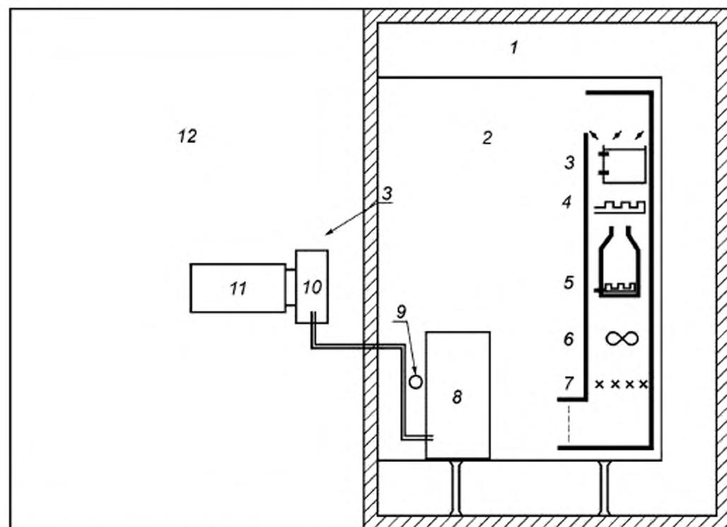
1 — пространство с регулируемой температурой воздуха; 2 — отсек наружной стороны; 3 — теплообменник для охлаждения; 4 — теплообменник для нагрева; 5 — увлажнитель; 6 — вентилятор; 7 — смеситель; 8 — наружный блок испытываемого оборудования; 9 — трубка отбора пробы воздуха; 10 — внутренний блок испытываемого оборудования; 11 — аппаратура измерения воздушного потока; 12 — отсек внутренней стороны
