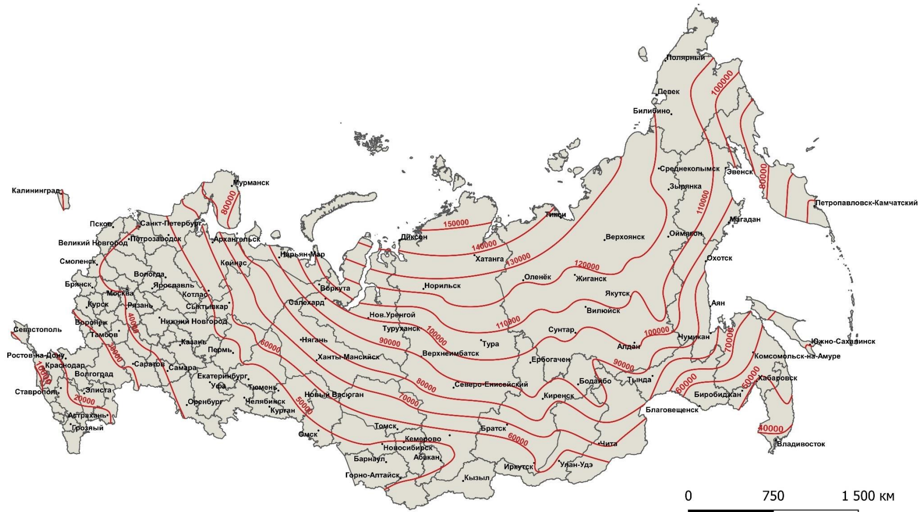
Рисунок E.8 – Климатологический фактор DH_{hps} , ^{\circ}\text{C}\cdot\text{ч} , при t_{\text{TH}} = 55^{\circ}\text{C} и h_t = 35^{\circ}\text{C} . Источник низкопотенциальной теплоты – грунт
