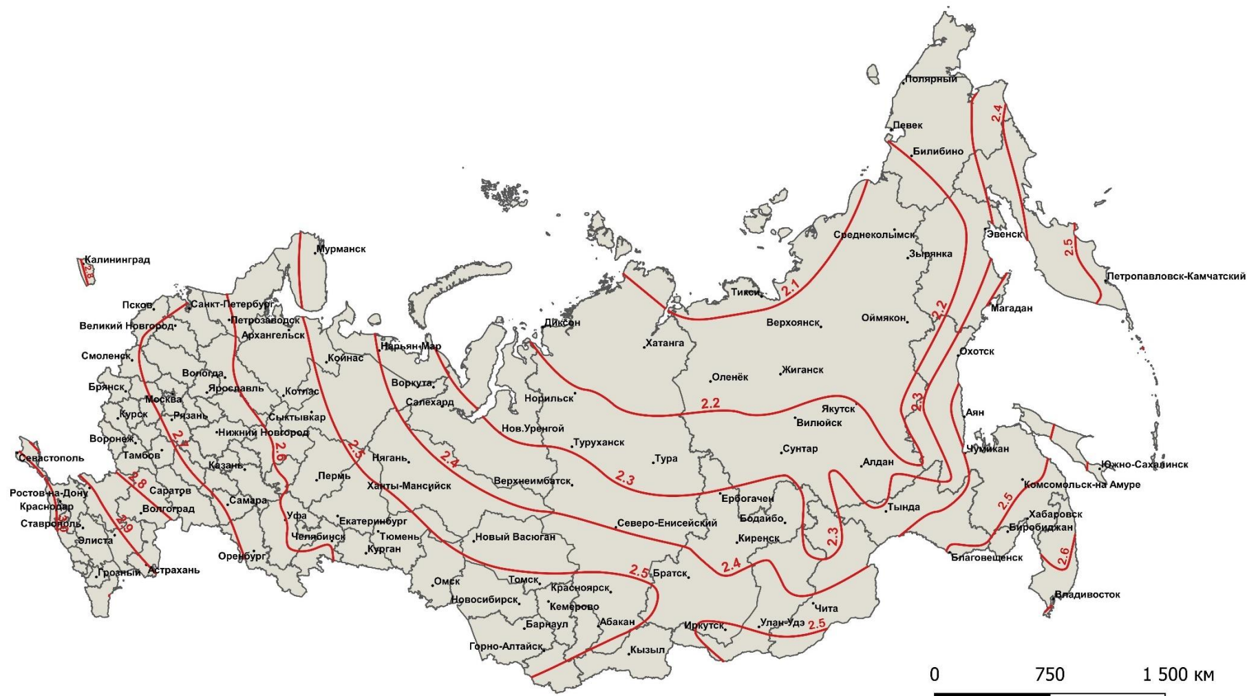
Рисунок E.1 – Коэффициент преобразования энергии теплонасосной системой теплоснабжения для горячего водоснабжения, дол. ед., при использовании в качестве источника низкопотенциальной теплоты грунта
