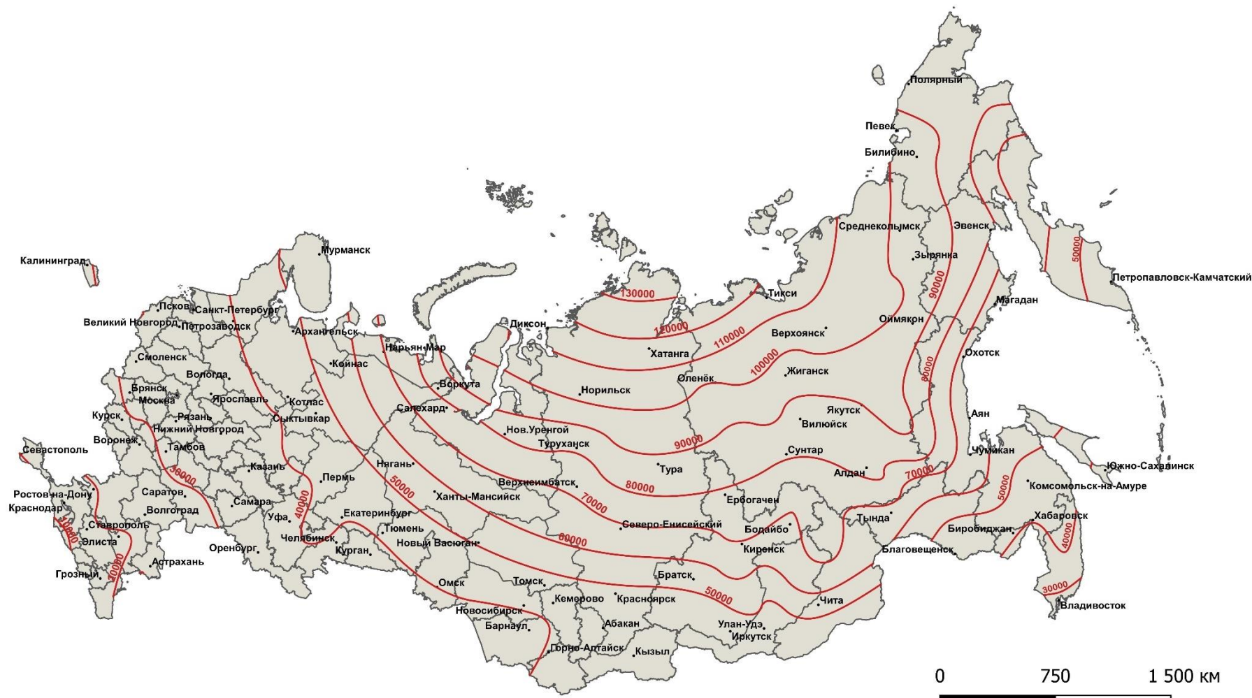
Рисунок Е.10 – Климатологический фактор DH_{hps} , ^{\circ}\text{C}\cdot\text{ч} , при t_{\text{TH}} = 55^{\circ}\text{C} и t_t = 35^{\circ}\text{C} . Источник низкопотенциальной теплоты – комбинация грунта и атмосферного воздуха
