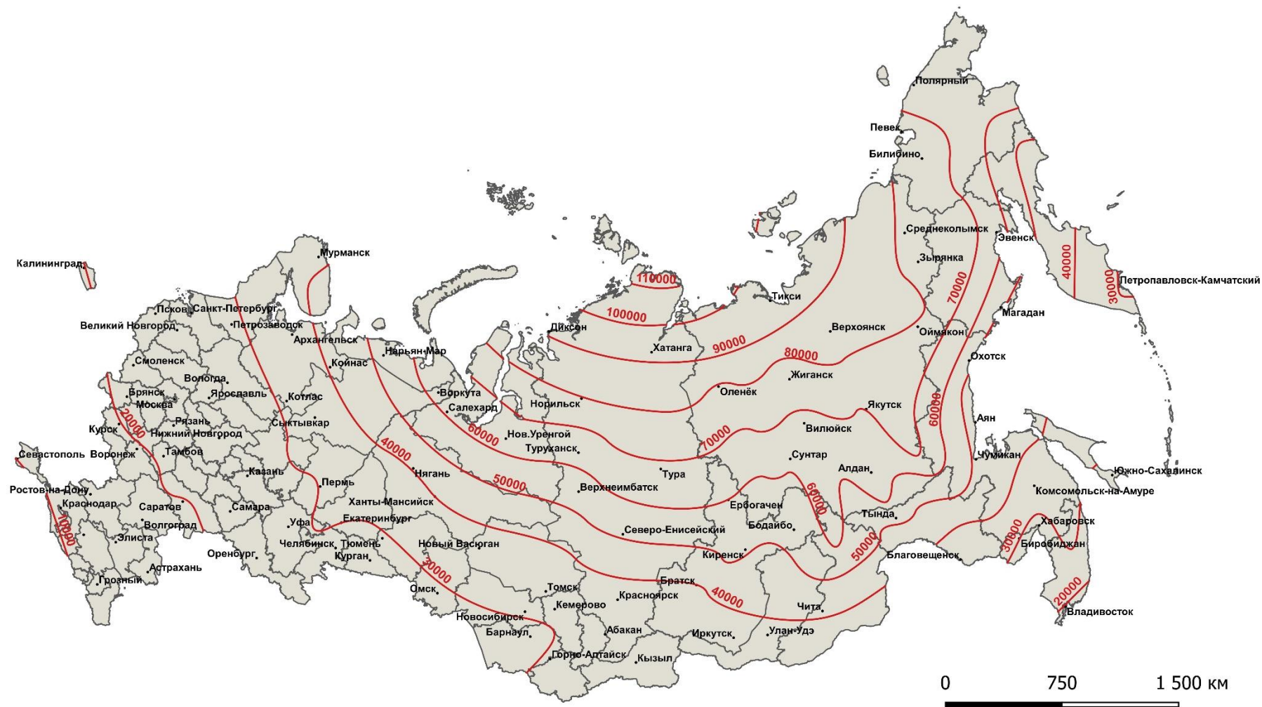
Рисунок E.9 – Климатологический фактор DH_{hps} , ^{\circ}\text{C}\cdot\text{ч} , при t_{\text{TH}} = 35^{\circ}\text{C} и h_t = 15^{\circ}\text{C} . Источник низкопотенциальной теплоты – комбинация грунта и атмосферного воздуха
