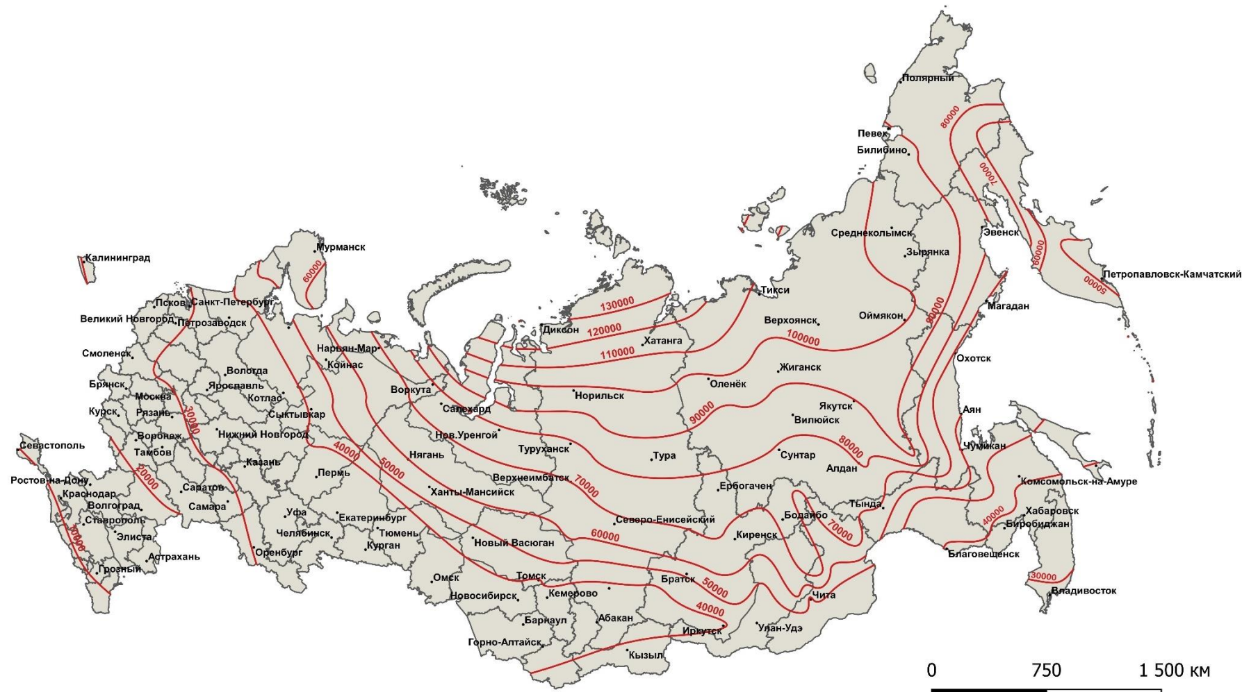
Рисунок E.7 – Климатологический фактор DH_{hps} , ^{\circ}\text{C}\cdot\text{ч} , при t_{\text{TH}} = 35^{\circ}\text{C} и h_t = 15^{\circ}\text{C} . Источник низкопотенциальной теплоты – грунт
